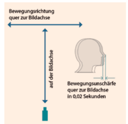
Bewegung auf der Bildachse sowie quer zur Bildachse.
